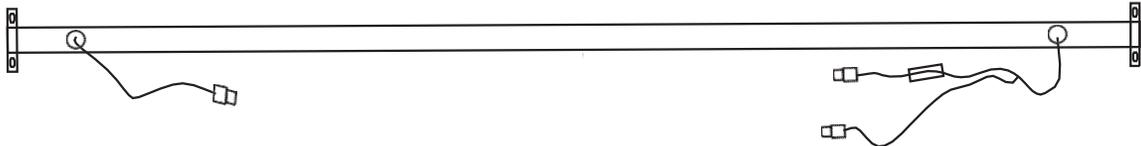
1. Insérez le fil du connecteur dans le trou pour le cacher, afin d'éviter que les fils ne s'emmêlent à l'extérieur.
