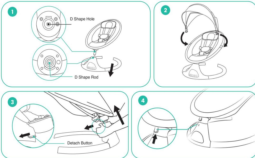
1. Insérez le cadre du siège dans la base, assurez-vous que la tige en forme de D est dirigée vers le trou en schiste D dans la base.
